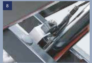
8 Vanne antidéflagrante : Empêche la chute de la nacelle en cas de fuite d'huile
