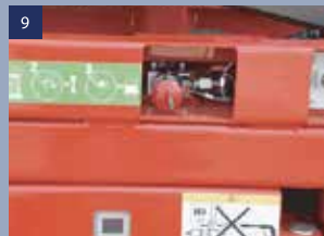
9 Soupape manuelle d'abaissement : En cas de panne du système de commande ou de batterie déchargée empêchant la plateforme de descendre, cette soupape permet de faire descendre la nacelle.
