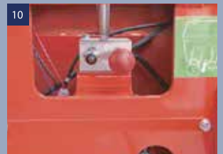
10 Soupape de décharge manuelle : Lorsque la nacelle ne peut plus bouger, il est possible de la pousser après avoir actionné cette soupape.
