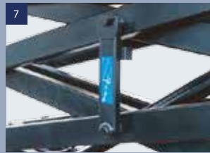
7 Bras de support : Assure la protection de l'opérateur lorsqu'il effectue des travaux de réparation ou de maintenance
