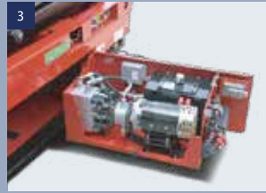
3 Système hydraulique et électrique
